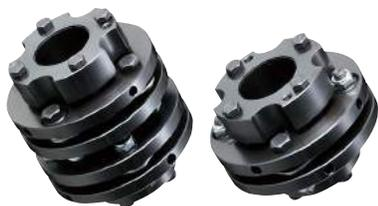
サーボモータの特性を最大限に活かせる、ノンバックラッシで高いねじり剛性を有した無潤滑のカップリングです。有限要素法に基づく最適形状のディスクは確実にトルクを伝達しながら、しなやかにミスアライメントを吸収します。
